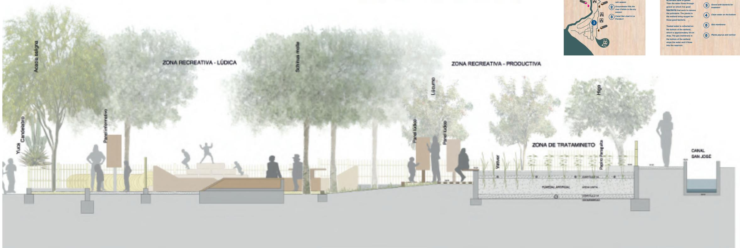
Reinigung des verschmutzten Wassers aus dem Bewässerungskanal durch Pflanzenkläranlage und Nutzung des gereinigten Wassers zur Bewässerung
