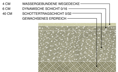
REGELDETAIL WASSERGEBUNDENE WEGEDECKE M 1:10
